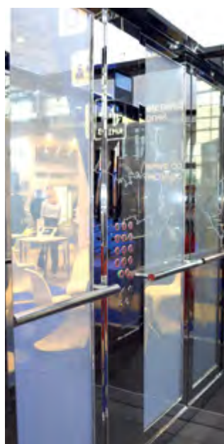
Стекло SmartGlass в режиме прозрачности
